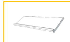
**14 - TABLETTE PRÉSENTOIR PORTE-REVUES:** Elle est fabriquée en tôle e=1 mm, ayant une inclinaison de 45° pour y exposer des livres de grand format et un rebord d'appui de 3,5 cm. Mesures 60/80/90/110 cm, longueur d'appui 33 cm..
