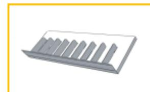
**11 - TABLETTE POUR COLLECTION :** Elle est fabriquée en tôle e=1 mm, inclinée à 45°. Elle comporte des séparateurs amovibles et un rebord d'appui de 14 cm de profondeur. Mesures 60/80/90/110 cm.
