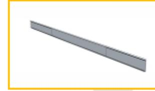
**25 - SIGNALISATION SOUDÉE POUR TABLETTE SUPÉRIEURE :** Elle est fabriquée en tôle métallique e=1 mm. Elle est munie de plis sur toute la longueur du chant de la tablette supérieure permettant ainsi d'y insérer des étiquettes. Une protection en plastique peut être ajoutée. Les étiquettes ne sont pas comprises. Mesures 60/80/90/110 cm
