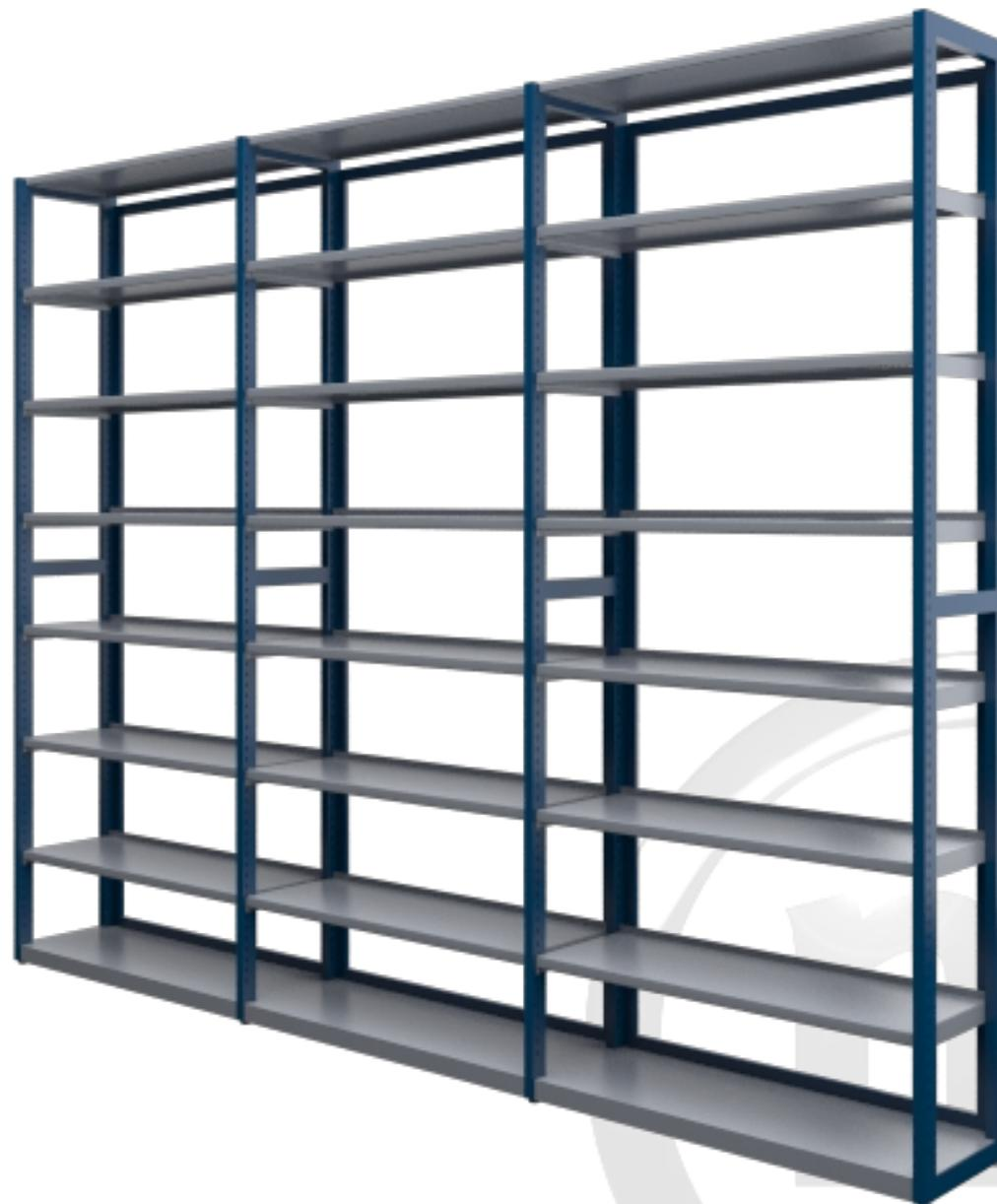
**Escalerillas:** Fabricadas con perfil de tubo de acero laminado frío DC01 con cantos rectos 40x25, 2mm de espesor, ranurado cada 25mm para poder graduar los estantes en altura, con tubos transversales mediante soldadura oxiacetilénica de hilo continuo. Incluye pies niveladores metálicos. Incluyen la mecanizaciones necesarias para poner costados decorativos en las escalerillas terminales.
