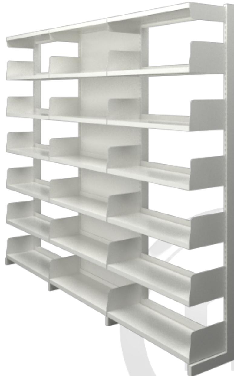
**Soportes**, tubo de sección rectangular de 60x30x2 mm provisto de doble ranuración a todo lo largo del soporte con pie de tubo de la misma sección, y provisto de niveladores. Se pueden incorporar costados terminales y sobre tapas de distintos materiales.
