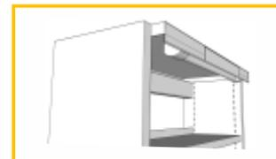
**26 - SYSTÈME D'ÉCLAIRAGE :** Il est fabriqué en tôle métallique e=1 mm. Il est muni de plis sur toute la longueur du chant de la tablette supérieure permettant ainsi d'y insérer des étiquettes. Mesures 60/80/90/110 cm.
