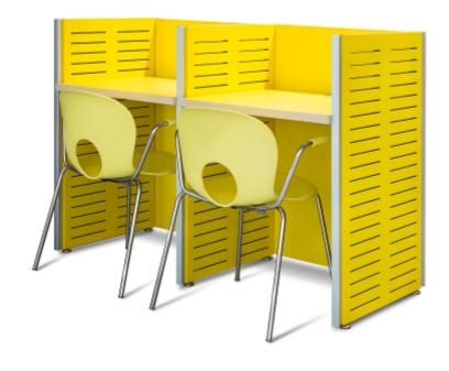
Costados: Conformados en chapa blanca tipo AP-02 de 1 mm de espesor, con doble chapa plegada. Terminación con pintura en polvo polimerizada a 200°C previo desengrasado y fosfatado. Frentes con perfil de aluminio de 30 mm acanalado para alojar las chapas, mecanizados para encastre de chapas mediante tornillería. Niveladores de nylon de 30 mm de espesor, atornillado sobre tuerca M10 insertada en el canto inferior del costado.
