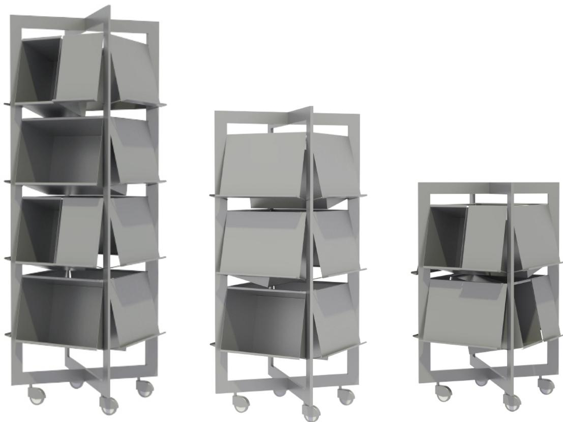
Se presenta el expositor de novedades de la serie "García Lorca" diseñado por Cayuelas\_Arquitectos para Metalundia, una pieza elegante y funcional formada por un doble marco en perfil tubular de 60x20 mm dispuesto en cruz. La estructura auxiliar de atriles y cajones de 1 mm, todo ello conformado en chapa blanca de acero laminado en frío, plegada, calidad DC01.
