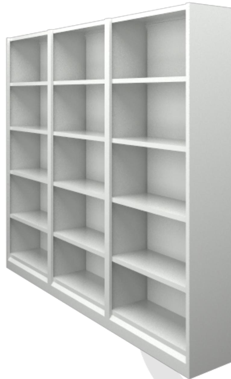
**Costados** conformados en chapa laminada frío tipo DC01 de  $e=0.8\text{mm}$ , plegada, mecanizadas cada 30mm para soporte de estante. Terminación con pintura en polvo polimerizada a  $200^{\circ}\text{C}$  previo desengrasado y fosfatado.
