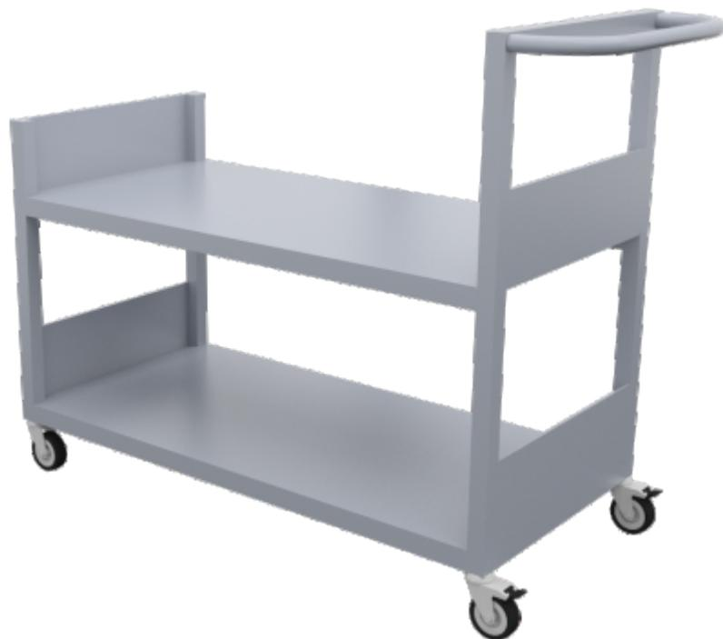
Carro portalibros totalmente metálico, fabricado con estructura metálica en tubo de 30×30 e=1.5 mm, bastidor inferior reforzado.
