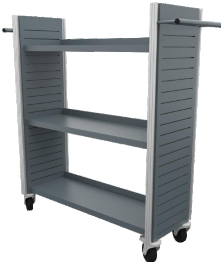
Carro portalibros totalmente metálico, fabricado con costados conformados con doble chapa plegada y ranurada, de tipo blanca AP-02 de  $e=1$  mm con pliegues longitudinales. Frentes con perfil de aluminio extrusionado de 30 mm acanalado y mecanizado para alojar los costados.
