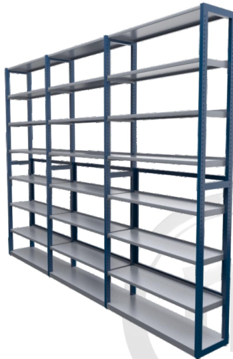
**Escalerillas:** Fabricadas con perfil de tubo de acero laminado frío DC01 con cantos rectos 40x25, 2mm de espesor, ranurado cada 25mm para poder graduar los estantes en altura, con tubos transversales mediante soldadura oxiacetilénica de hilo continuo. Incluye pies niveladores metálicos. Incluyen la mecanizaciones necesarias para poner costados decorativos en las escalerillas terminales.
