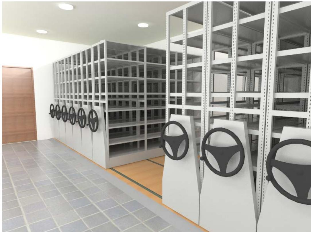
Sistema de estanterías móviles formado por un conjunto de estanterías montadas sobre plataformas deslizantes, que se desplazan mediante un sistema de tracción determinado a lo largo de unos raíles. Dichos raíles pueden ir sobre el suelo o empotrados en el mismo, dependiendo de las condiciones de cada equipamiento concreto.
